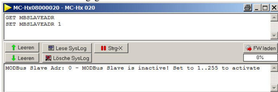
Die Antwort zeigt die Werkseinstellung mit dem deaktivierten MODBus Slave an. Mit dem folgenden Befehl „SET MBSLAVEADR 1“ wird dann die Slave-Adresse gesetzt und der MODBus Slave Modus aktiviert.
